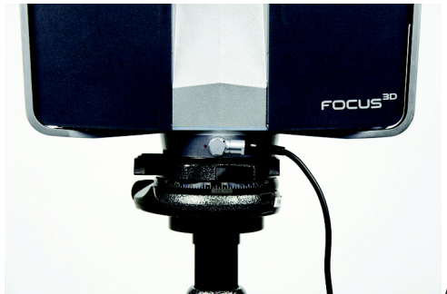
图 0-15 电源已连接到 Focus 3D
